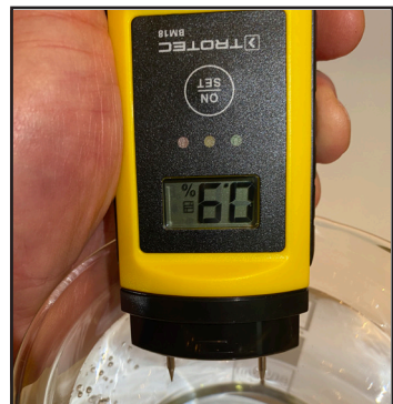
Bild 19a Leitwertmessung in destilliertem Wasser
