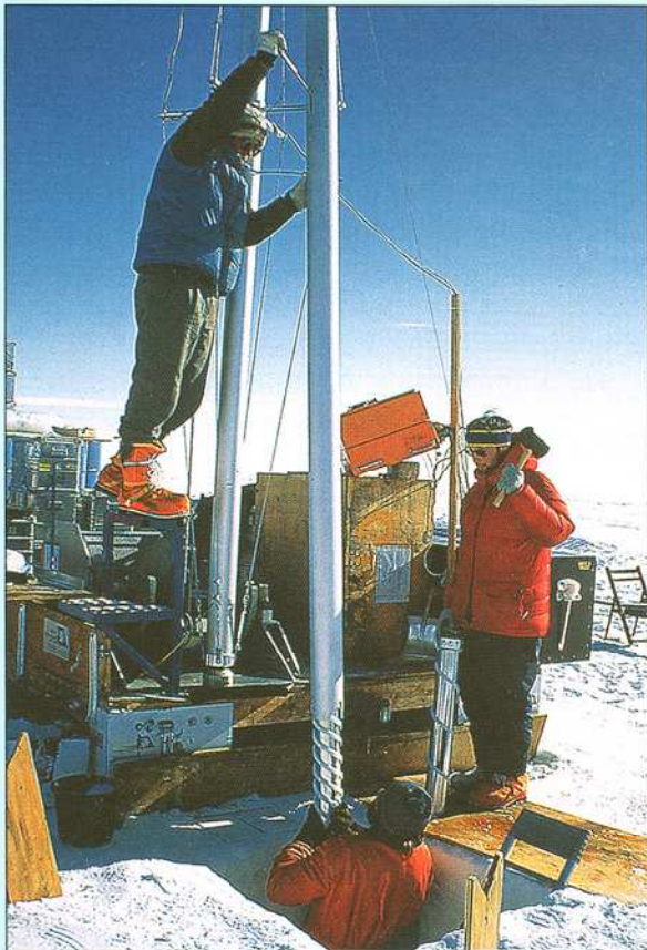
Priprema bušotine za vađenje uzorka iz dubine ledenog antarktičkog pokrova.
