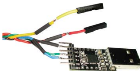
Slika 2.1.1.g Zalemljeno na savijenu letvicu sa izvodima
