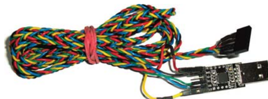
Slika 2.1.1.h Zalemljeni adapterski kabl spreman za upotrebu
