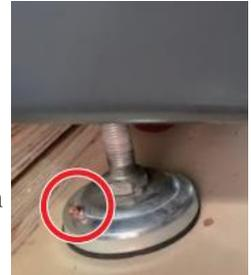
**Schritt 2:** Befestigen Sie die Bremsbeläge an beiden Vorderrädern, indem Sie sie nach unten drücken und Ihre Füße nach unten drehen. Bei Bedarf können auch passende Befestigungen mit 5 mm Löchern verwendet werden, um die Graviermaschine besser zu befestigen.
