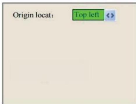
Dieses Menü legt die relative Nullposition fest. Für unterschiedliche Nulllagen können unterschiedliche Spiegelbilder des Graphen durch die X/Y-Achse erzeugt werden. Der Vorgang ist derselbe wie oben.
