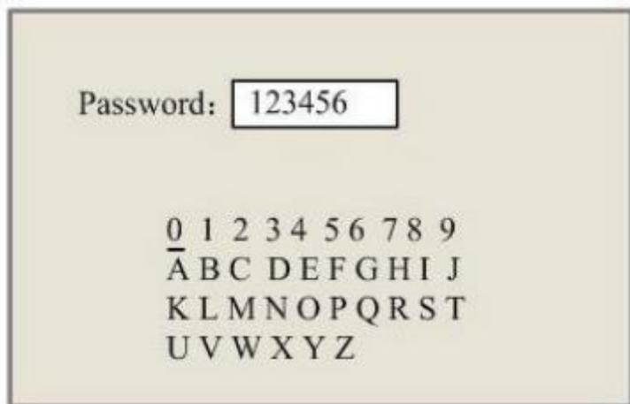
Drücken Sie ◀ oder ▶ und ▲ oder ▼, um das Passwort auszuwählen, und speichern Sie es mit der „Enter“-Taste. Die aktuellen Parameter des Geräts werden als Standard gespeichert. Sie können sie dann mit dem Befehl „Restore Default Settings “ abrufen. Es wird empfohlen, die
