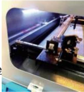
Richtungspfeile auf dem Bedienfeld, um Spiegel 2 zu bewegen. Spiegeln Sie entlang der Y-Achse zur Rückseite des Bettes.
