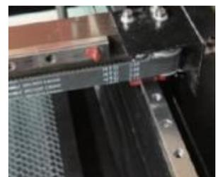
Schmiermittel gleichmäßig auf den beiden Schienen verteilt wird, und heben und senken Sie die Basis, um das Schmiermittel gleichmäßig auf den Schrauben zu verteilen.
