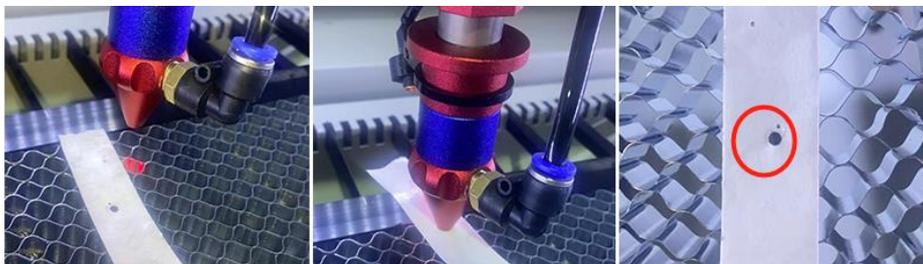
Nachdem der Laser auf dem gesamten Weg vom Rohr bis zum Tisch gut zentriert ist, sind alle Laserspiegel korrekt kalibriert und können mit optimaler Effizienz betrieben werden (sofern sie sauber sind).
