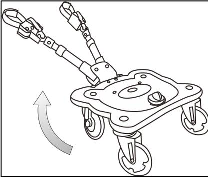
**Lösen Sie den Schraubknopf, verlängern Sie die Verbindungsarme und klappen diese nach oben.**
