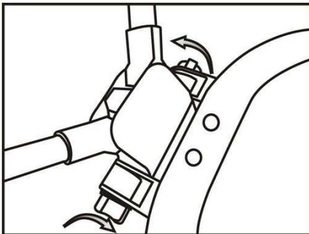
**Passen Sie die Plattform an, so dass diese parallel zum Fußboden steht und alle 4 Räder den Boden berühren.**
