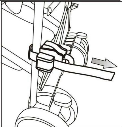
**Suchen Sie eine geeignete Stelle am hinteren Gestänge des Kinderwagens, wickeln die Lasche herum und führen diese durch die Halterung durch. Ziehen Sie die Lasche so kräftig wie möglich an.**
