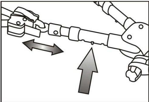
**Passen Sie die Länge der Verbindungsarme an.**
