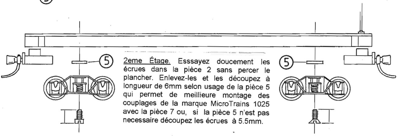
2eme Étage. Essayez doucement les écrous dans la pièce 2 sans percer le plancher. Enlevez-les et les découpez à longueur de 6mm selon usage de la pièce 5 qui permet de meilleure montage des couplages de la marque MicroTrains 1025 avec la pièce 7 ou, si la pièce 5 n'est pas nécessaire découpez les écrous à 5.5mm.
