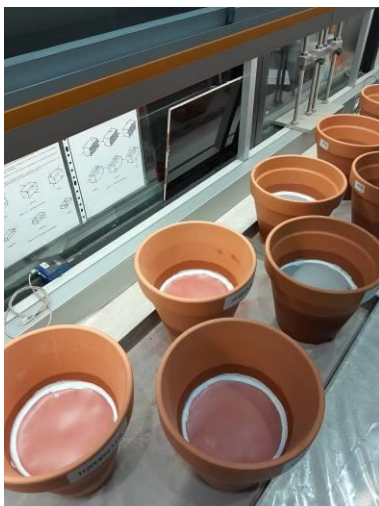
Barreras geosintéticas colocadas y selladas
