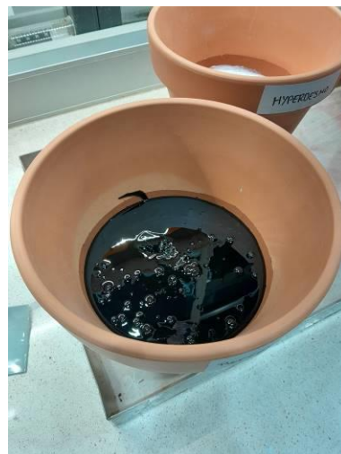
Vasija de referencia con 20 mm de espesor de betún
