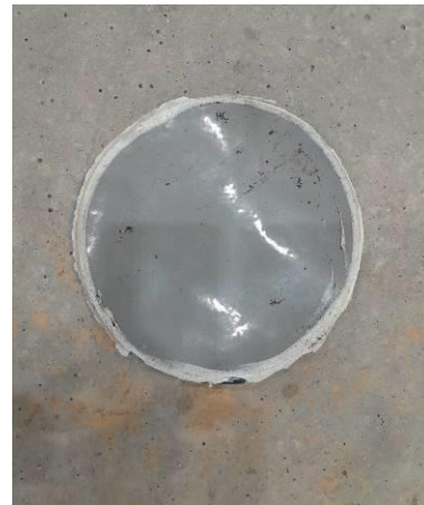
Aspecto de la barrera geosintética tras el ensayo
