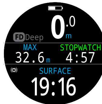
Cronômetro é mostrado por padrão nos modos de Instrumentos e de Mergulho Livre.
