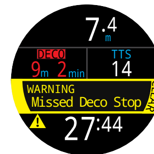
9. Sosta decompressiva omessa
