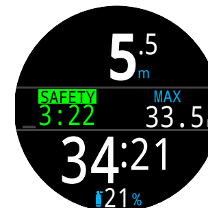
6. Sosta di sicurezza
