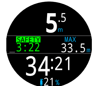
6. Parada de seguridad
