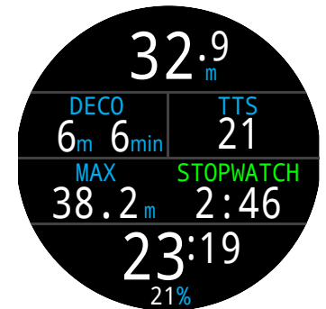
El cronómetro se puede agregar a la pantalla principal en cualquier modo.
