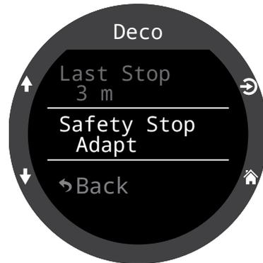
使用「調整」(Adapt) 設定時，會使用 3 分鐘的安全停留。但若潛水超過 30 公尺 (100 英尺) 或免減壓時間低於 5 分鐘，則會使用 5 分鐘的安全停留。
