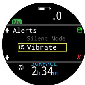
潛水工具選單中也有測試警示工具，應在潛水前定期使用，以確保震動器正常運作。
