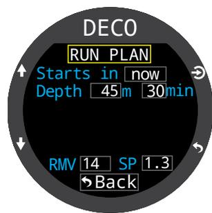
輸入預期的水面間隔時間、底部深度、水底時間和呼吸分鐘容積 (RMV)。
