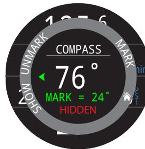
您可在此彈出畫面中標記與消除航向圖示，也能設定是否覆蓋顯示指北針外圈的航向。
