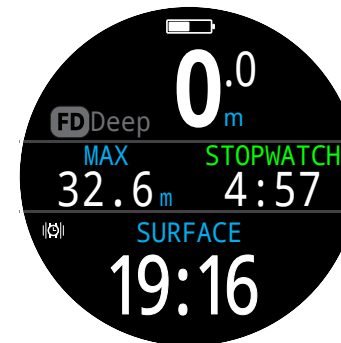
Stoper pojawia się domyślnie na ekranie startowym w trybach Gauge i Freedive.
