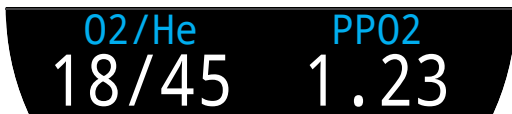
แถวข้อมูลตั้งต้นในโหมด OC Tec รูปแบบหน้าจอ “มาตรฐาน”
