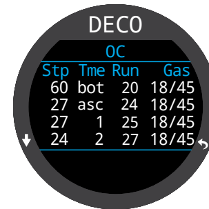
3. วางแผนการดำน้ำ - การพักน้ำที่กำหนดไว้
