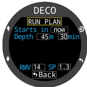
Ingrese el intervalo en la superficie previsto, la profundidad máxima de la inmersión, el tiempo de fondo, el volumen respiratorio por minuto (RMV) y el valor de ajuste (solo en circuito cerrado).
