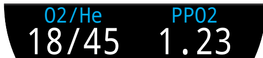
OC Tecモードのデフォルトの情報欄。標準レイアウト
