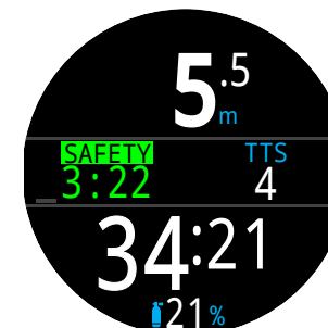
6. Sosta di sicurezza
