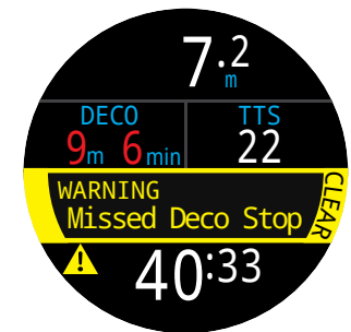
9. Sosta decompressiva omessa
