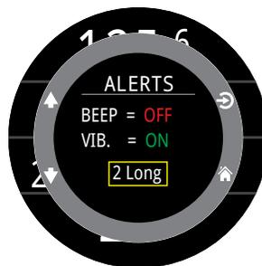
Im Menü „Tauchtools“ steht ein Tool zum Testen von Alarmen zur Verfügung und sollte regelmäßig vor dem Tauchen verwendet werden, um sicherzustellen, dass der Signalgeber und die Vibrationsvorrichtung ordnungsgemäß funktionieren.
