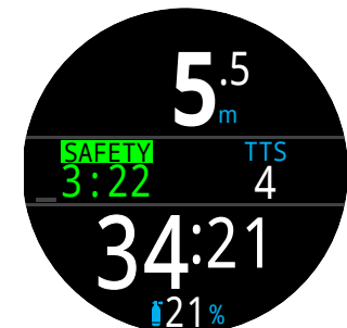
6. Safety Stop (Palier de sécurité)
