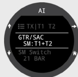
Ajout d'une fonction d'affichage RTR (Temps de secours restant). Cela correspond au calcul de la valeur GTR (TGR) de la bouteille la moins remplie (c'est-à-dire le GTR [TGR] en cas de perte de la bouteille ayant le plus de gaz).
