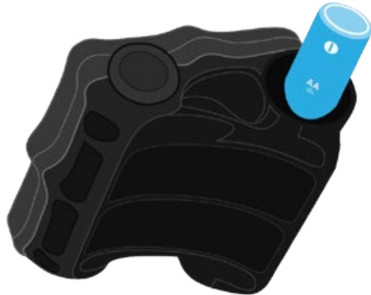
図23 バッテリーの交換
