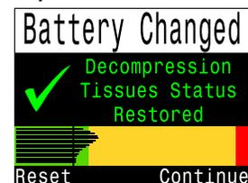
FIGURA 26 Después del cambio de batería, se muestran los tejidos restaurados (con la opción de restablecerlos).
