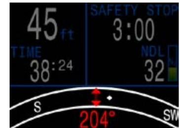
El rumbo recíproco ( $180^\circ$  del rumbo marcado) se muestra con una flecha roja.
