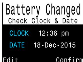
FIGURA 24 Después de sustituir la batería, se mostrará una pantalla para hacer ajustes rápidos a la hora.
