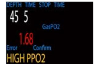
El error de mayor prioridad se muestra primero. Si se producen varios errores simultáneamente, verá el error con la prioridad más alta. Borre el primer error presionando SELECT (derecha) para ver el siguiente error.
