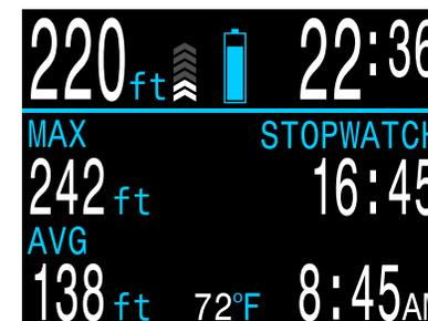
FIGURA 5 Modo Gauge (Profundímetro)
