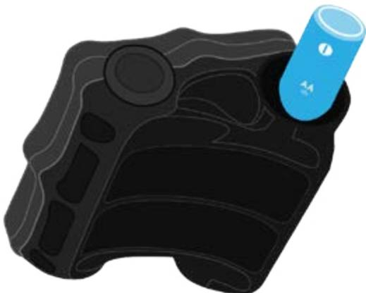
FIGURA 23 *Cambio de la batería*
