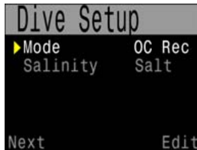
ABBILDUNG 1 Einstellen des OC Rec-Modus
