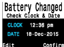
FIGURE 24 Après avoir remplacé la pile, un écran s'affiche qui permet un réglage rapide de l'heure.
