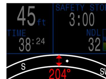
Le cap inverse ( $180^\circ$  du cap marqué) est affiché avec une flèche rouge. Lorsque vous êtes dans une plage de  $\pm 5^\circ$  du cap inverse, l'affichage des degrés passe en rouge.
