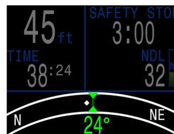
Le cap marqué est affiché par une flèche verte. Lorsque vous êtes dans une plage de  $\pm 5^\circ$  du cap, l'affichage des degrés passe en vert.
