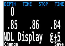
Per esempio, durante un'immersione su un relitto, si rimane nella parte più profonda fino ad accumulare la decompressione e la TTS desiderate. Risalendo al secondo ponte della nave, si nota che i valori @+5 e TTS sono uguali. Ciò significa che si possono trascorrere 5 minuti esplorando questo ponte senza incorrere in decompressione aggiuntiva.
