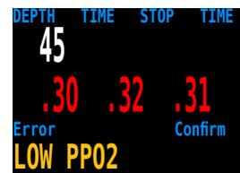
Non è raro ricevere tale errore immediatamente dopo essersi immersi con un CCR manuale e una miscela ipossica. Il primo respiro in immersione riempie il circuito con gas a PPO<sub>2</sub> bassa. In genere, la situazione si risolve aumentando la profondità in modo che quando si presenta l'errore la PPO<sub>2</sub> non sia più bassa.
