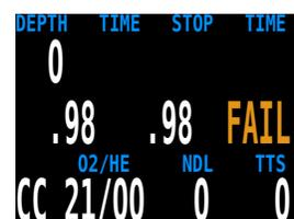
Una volta completata l’operazione, viene visualizzato un rapporto, che indica quali sensori hanno superato la calibrazione riportando il valore previsto della PPO<sub>2</sub> in base alla pressione barometrica e alla FO<sub>2</sub>.
