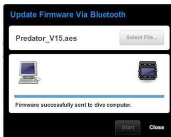
La schermata del Petrel aggiorna il percentile della ricezione del firmware e, ultimato il processo, il PC visualizza il messaggio “Firmware successfully sent to the computer” (invio del firmware al computer riuscito).
