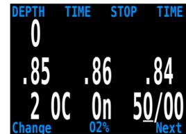
Premendo il pulsante SELECT sull'ultima cifra, si conclude la modifica di quel gas (Save) e si ritorna al numero del gas. I gas la cui impostazione di ossigeno ed elio è pari a 00, non vengono visualizzati nella funzione "Select Gas" (Selezione Gas).
