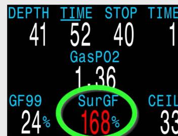
*Surface GF (GF en la superficie) es el factor de gradiente si ascendiera a la superficie de inmediato.*
