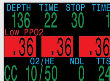
En caso de alarma por PPO2 baja o alta proveniente de un controlador externo, la alerta vibratoria continúa incluso después de borrar el mensaje de Advertencia
