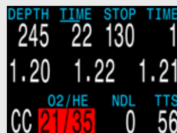
Das CC-Diluent wird rot angezeigt, um anzugeben, dass ein direktes Atmen unsicher ist ( PO_2 > 1,6 ).
