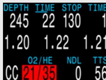
密閉系統稀釋氣體變成紅色時代表不安全，無法直接吸入（氧分壓 > 1.60）
