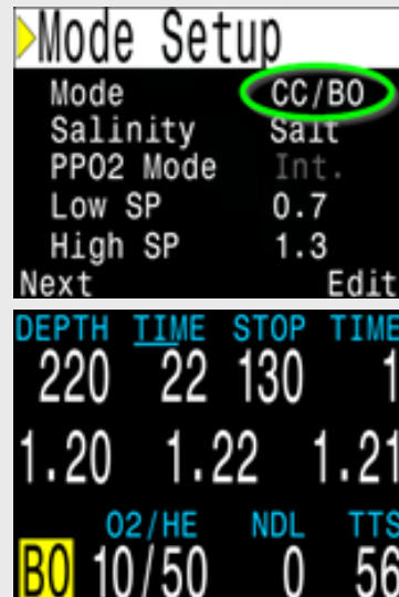
El modo OC/CC ahora se llama CC/BO para que su función sea más clara.
