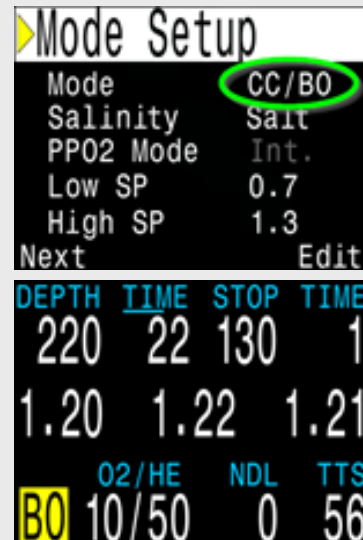
Le mode « OC/CC » (Circuit ouvert/Circuit fermé) a été renommé « CC/BO » (Circuit fermé/Réserve auxiliaire) pour plus de clarté
