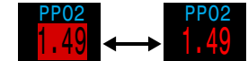
重大な警告の例 - このガスを呼吸し続けると命の危険にかかります
