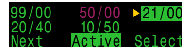
21% O2是當前啓用的氣體，按動Select退出選單不做任何更改。
