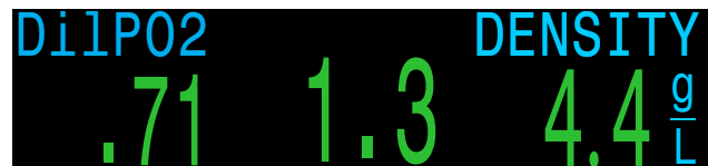
使用内部设定点时，可在CC/BO模式下配置左右两侧位置的信息。
