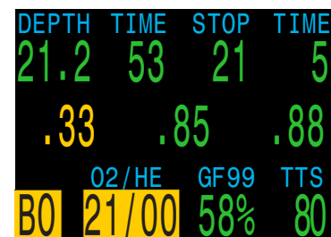
14.气体切换 气体切换
