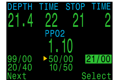
Layout do menu de seleção de gás no estilo novo. 5 gases programados e ligados no momento
