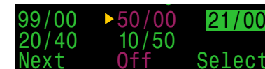
50 % O 2 deaktiviert. „Auswählen“ drücken, um zu 50 % zu wechseln und Gas zu aktivieren.
