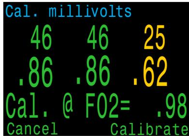
Pour modifier la FO<sub>2</sub> du gaz de calibration, accédez au sous-menu Conf. O<sub>2</sub> du menu Config. système.
