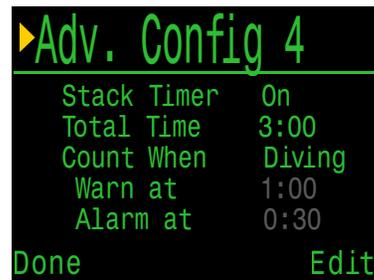
Lorsque le chrono temps de chaud est activé, les informations concernant la chaud utilisée et restante sont visibles sur l'écran. Le chrono temps de chaud peut aussi être réinitialisé depuis le menu de premier niveau. En revanche, il est impossible de le réinitialiser en cours de plongée.
