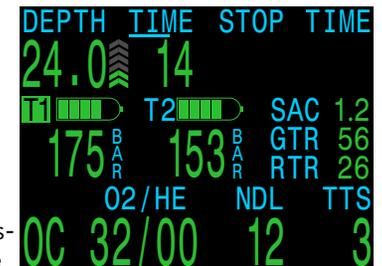
Le réglage de notification de changement de bloc peut être configuré entre 7 et 69 bar, ou 100 et 999 PSI.
