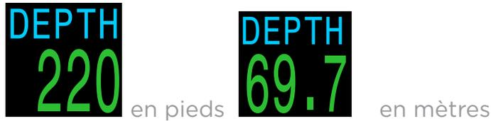
En pieds, la profondeur est affichée sans décimale. En mètres, elle est affichée avec une décimale jusqu'à 99,9 m.
