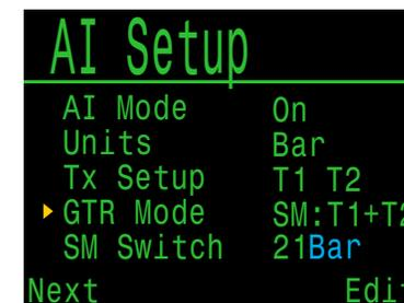
Le TGR et la CAS prennent en compte un seul bloc, ou deux blocs en configuration sidemount. Notez qu'en configuration sidemount, les deux blocs doivent avoir un volume identique pour garantir une valeur CAS correcte.
