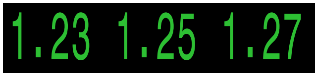
Środkowy wiersz wyświetla PPO2 w trybie CC/BO z monitorowaniem 3 czujników tlenowych.
