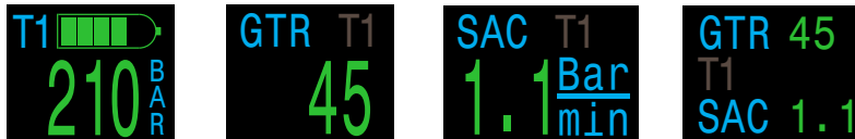
Presión de la botella Tiempo restante para ascenso con gas en presión de reserva Consumo de aire en la superficie Pantalla combinada de AI
