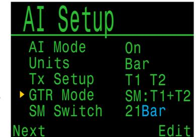
Il GTR e il SAC sono basati solo su una bombola oppure su due nella configurazione sidemount. Per quest'ultima, si noti che le bombole devono essere di volume identico affinché il SAC sia accurato.
