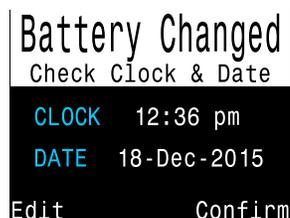
*Dopo la sostituzione della batteria, appare una schermata per la regolazione rapida dell'ora*
