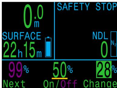
**Nota:** il gas evidenziato è quello attualmente attivo. Non si può disattivare il gas attivo. Lo si può modificare, ma per disattivarlo è necessario eseguire un cambio gas.
