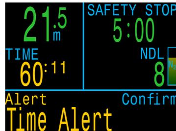
L'avviso tempo si attiva una sola volta per immersione.
