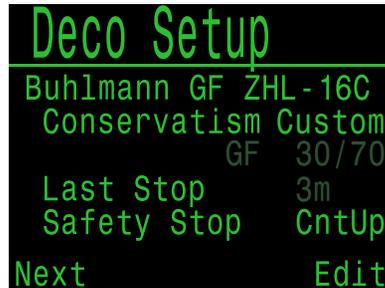
Optional können die Dekompressionsalgorithmen VPM-B und DCIEM gebührenpflichtig freigeschaltet werden. Bei Anwendung kann der Benutzer im Dekomodell zwischen den verfügbaren Algorithmen wechseln.
