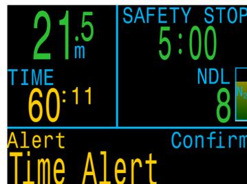
Der Zeitalarm wird nur einmal pro Tauchgang ausgelöst.
