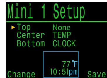
Bei vollständig sichtbaren Minianzeigen können sechs benutzerdefinierbare Felder gleichzeitig angezeigt werden. Sollten diese nicht sorgsam konfiguriert werden, kann die Menge der angezeigten Informationen Verwirrung stiften.
