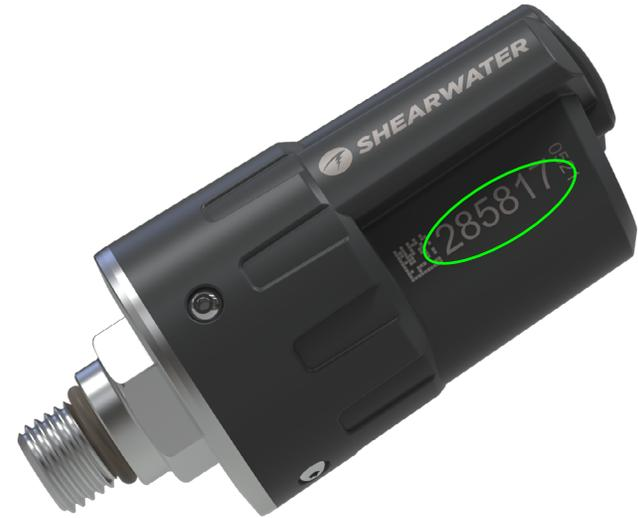
Das Koppeln des Senders erfolgt mithilfe der Menüoption „Senderein.“ und Auswahl von „T1“. Schalten Sie T1 ein, und geben Sie anschließend die sechsstellige Seriennummer für die Einstellung „T1-Seriennr.“ ein. Sie müssen dies nur einmal tun, da die Nummer dauerhaft im Einstellungsspeicher gespeichert wird.
