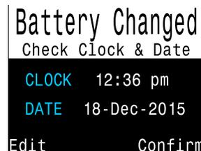
*Nach dem Wechseln der Batterie wird ein Bildschirm für die schnelle Einstellung der Uhrzeit angezeigt.*
