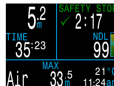
6. Sosta di sicurezza
