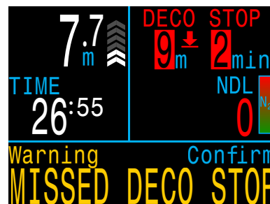
10. Sosta decompressiva omessa
