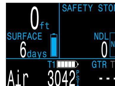
FIGURA 9 **Pantalla principal (modo OC Rec) en la superficie**
