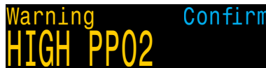
ตัวอย่างการแจ้งเตือนหลัก - ค่าเตือน PPO2 สูง
