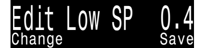
กดปุ่ม Change (เปลี่ยน) เพื่อเพิ่มค่า Setpoint
