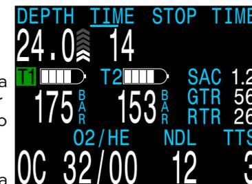
La configuración de la notificación de cambio tiene un rango de 7 a 69 bar, o 100 a 999 PSI.
