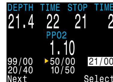
Diseño del estilo Nuevo del menú Escoger gas. Hay 5 gases programados y activados.
