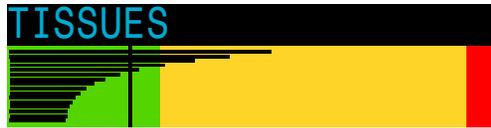
O gráfico de barras de tecidos mostra as tensões de tecido de gás inerte nos compartimentos de tecido conforme o modelo Bühlmann ZHL-16C.
