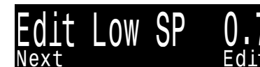
L'opzione Modifica valore di riferimento basso mostra il valore di riferimento in uso
