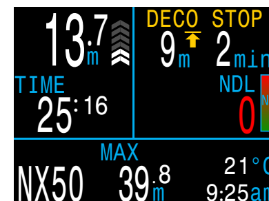
9. Avvicinamento alla sosta decompressiva
