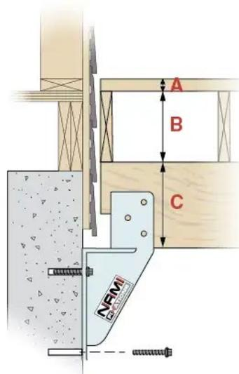
**NOTES:** La fixation de ces supports nécessite une fondation d'au moins 6" d'épaisseur. (15 MPA). Ne les installez pas sur une fondation en bloc.
