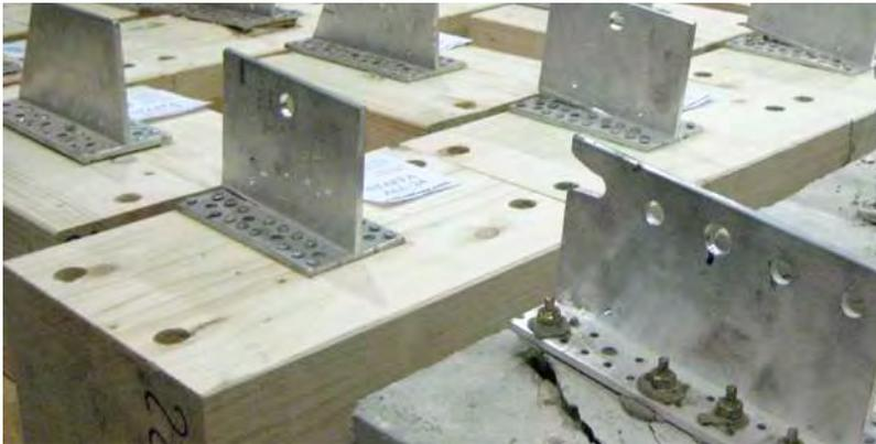
Essais sur des échantillons de taille réduite (bois-bois et bois-béton).
