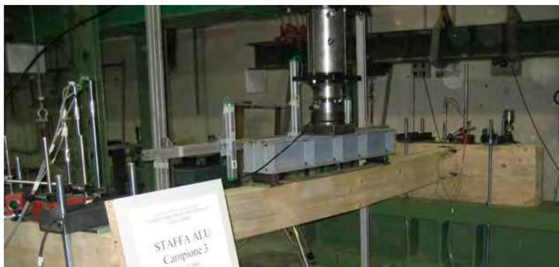
Essais sur des échantillons de taille réelle (assemblage poutre principale - poutre secondaire).
