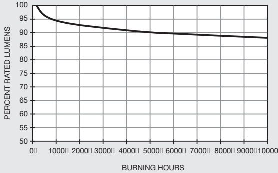
Lumen Maintenance Curve DULUX® S, S/E, D, D/E, T & T/E
